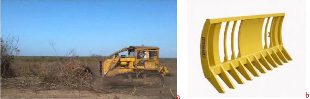
**Figura 2:** Enleiramento com ancinho enleirador (a). Lâmina tipo ancinho (b).
