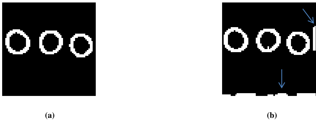
Figura 7. 10. Comparação entre os resultados para o operador de Sobel – (a) MATLAB; (b)NIOS.
