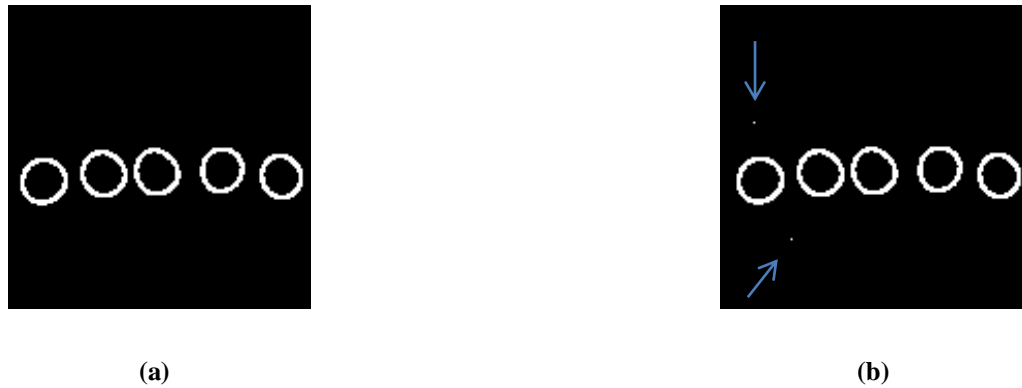
Figura 7. 7. Comparação entre os resultados para o operador de Sobel – (a) MATLAB; (b)VHDL.
